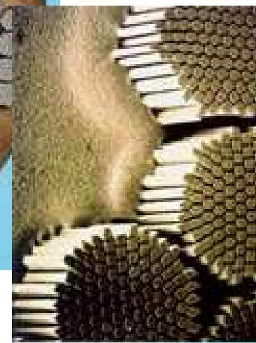
Сверху: многожильный кабель (36 жил, полный диаметр около 15 мм), снизу: сечение одной жилы (диаметр около 1.5 мм) в разных масштабах. Каждая жила содержит около 6300 «волосков» сверхпроводящего провода (NbTi) толщиной около 6 мкм в матрице из бескислородной меди.
